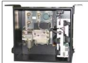
ブレーキ制御装置
