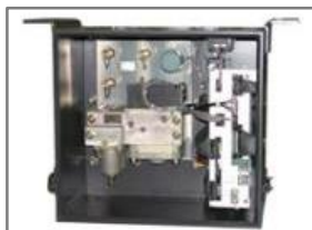
ブレーキ制御装置
